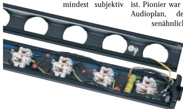
Gut erkennbar: die sternförmige Verdrahtung der Bullet AC Express Power
